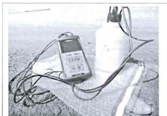
Photo 2 : mesure direct avec le pH-mètre multi paramètre
