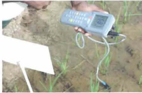
Figure 8 : Mesure de la conductivité électrique à l'aide d'un conductivimètre
