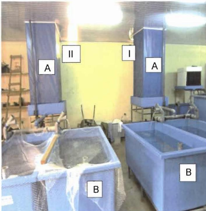
I : circuit I ; II : circuit II ; A : biofiltre ; B : bac
