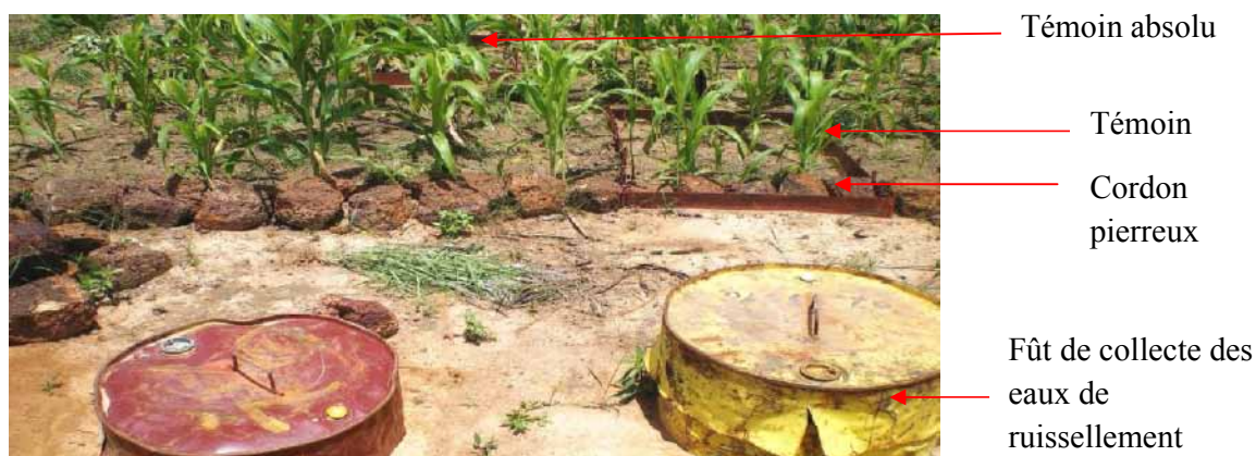
Photo 4.1 : Dispositif de collecte d'eau de ruissellement montrant la parcelle témoin et le témoin absolu.
