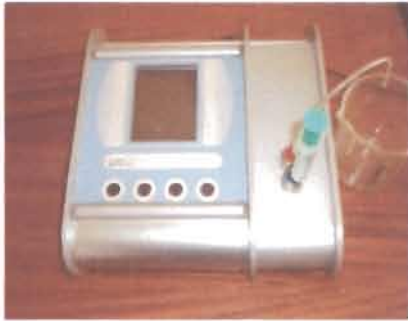
Photo1 : Machine d'analyse de la composition chimique du lait cru appelée Farm Milk Analyser.
