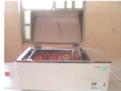
Photo 2 : Bain-marie contenant des aliquotes, et utilisé pour porter la température du lait à 40°C
