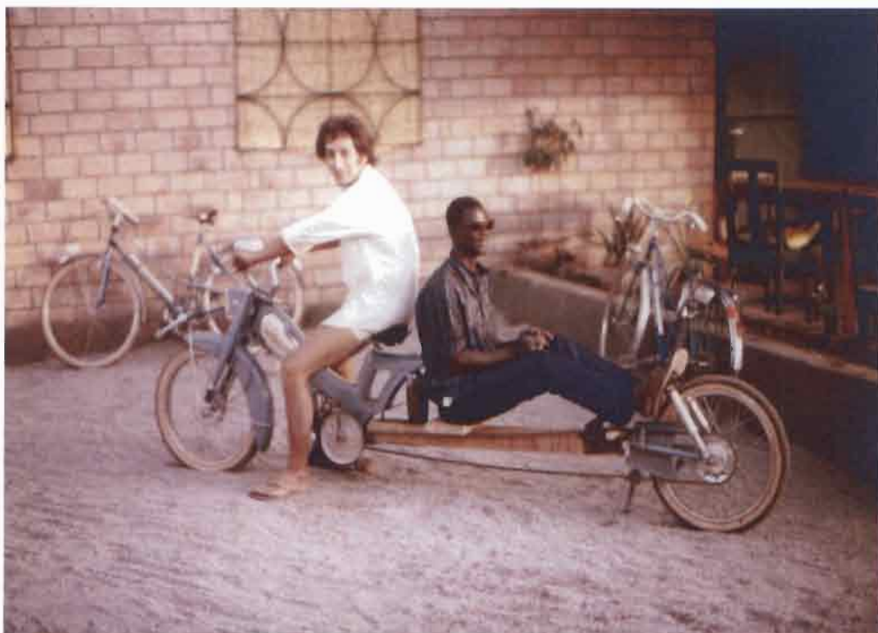
ICONOGRAPHIE 7 :Cyclo-Ambulance destinée au transport des malades de cholera sous perfusion en INDE.
