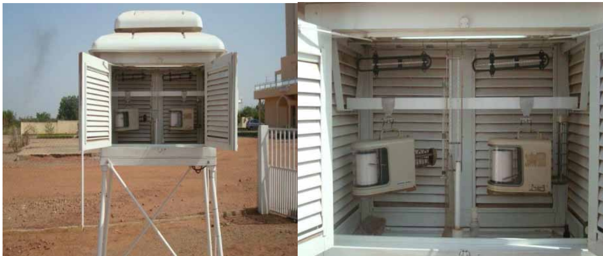
Iconographie 2: Abris météo (contenant thermographe en bas à gauche, thermomètre mini en haut à gauche, thermomètre maxi en haut à droite, et hygromètre en bas à droite).
