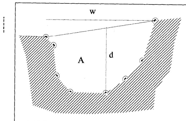
Figure 4: Exemple d'une section de ravin (section 10 en 2000). Le ravin a une largeur ( $w$ ) de 6.05 m, une profondeur ( $d$ ) de 3.59 m et la superficie de la section est  $15.63 \text{ m}^2$ . Les cercles indiquent les points mesurés avec le theodolite.
