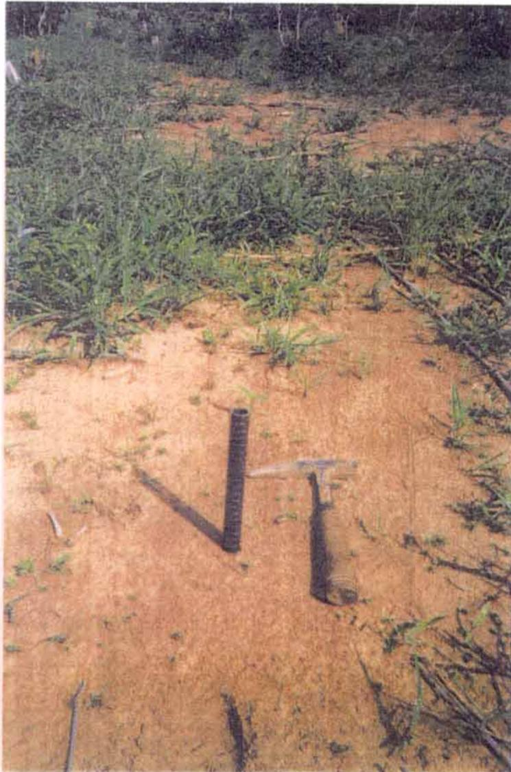
Cliché n° 20: Dispositif (piquet d'érosion en tube PVC gradué) pour mesurer le décapage péliculaire et les dépôts solides.
