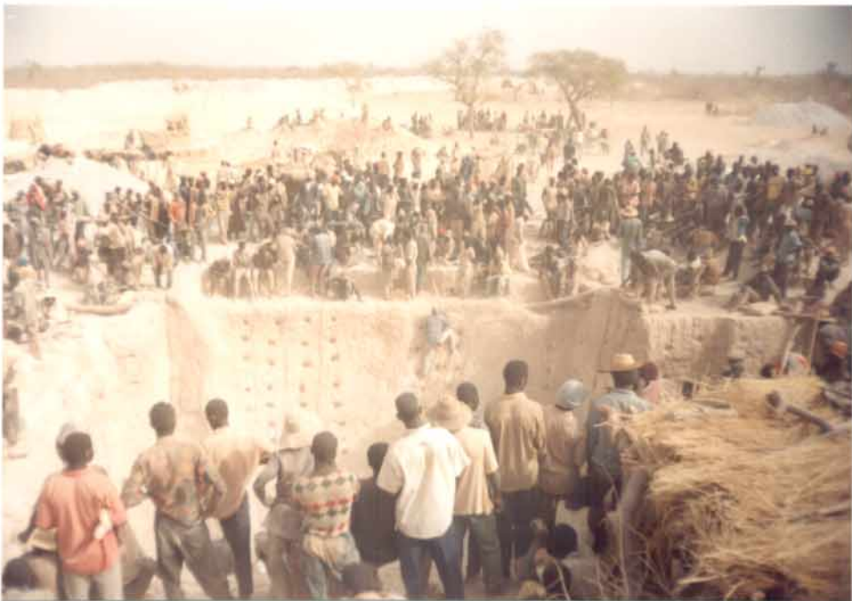
PHOTO 6 : Le fossé principal du site aurifère de Bouda est le résultat de la coalescence de plusieurs puits consécutifs.
