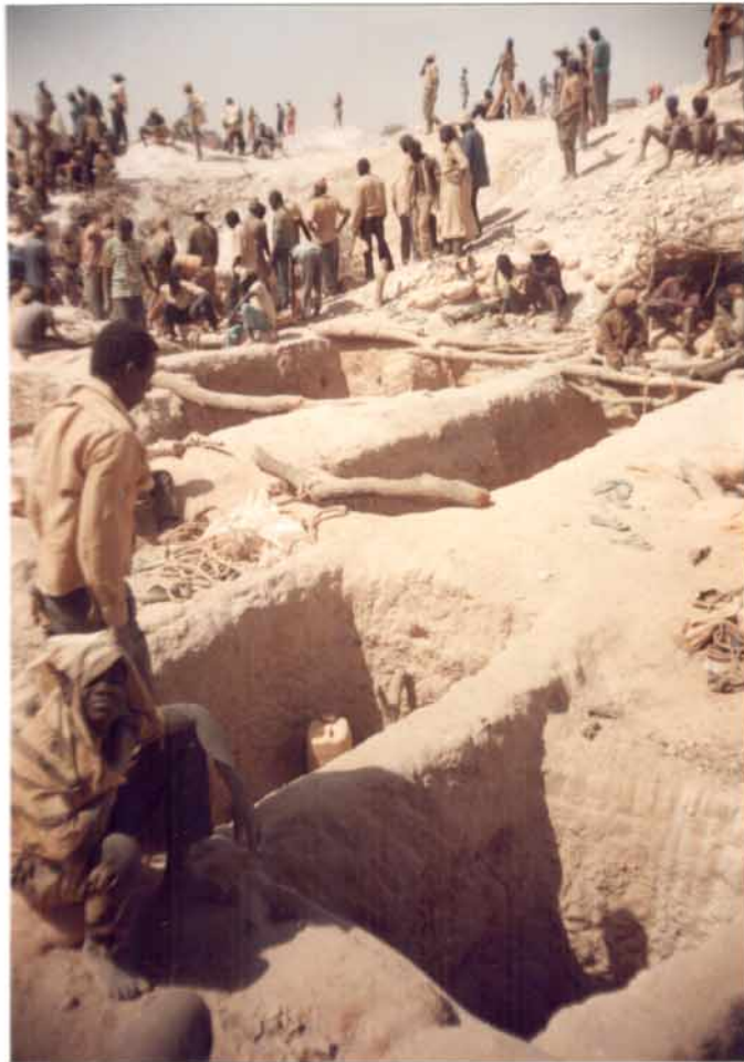
PHOTO 7 : Les puits sont généralement rapprochés et fusionnent parfois ; c'est une stratégie employée par les orpailleurs pour mieux poursuivre la couche riche.
