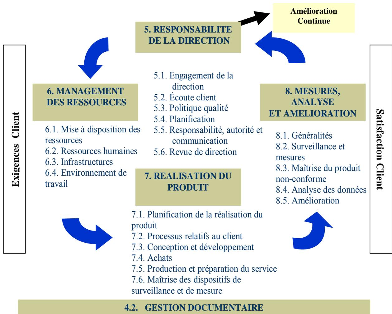
**Figure 1: Structure de la norme ISO 9001: 2000**
