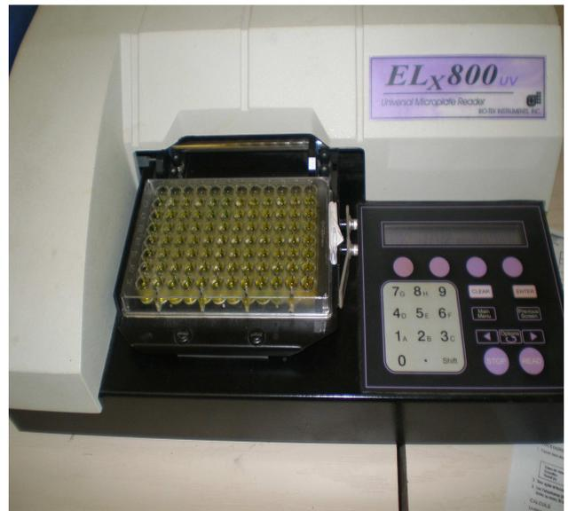
**Photo 2 : Spectrophotomètre à plaque**
