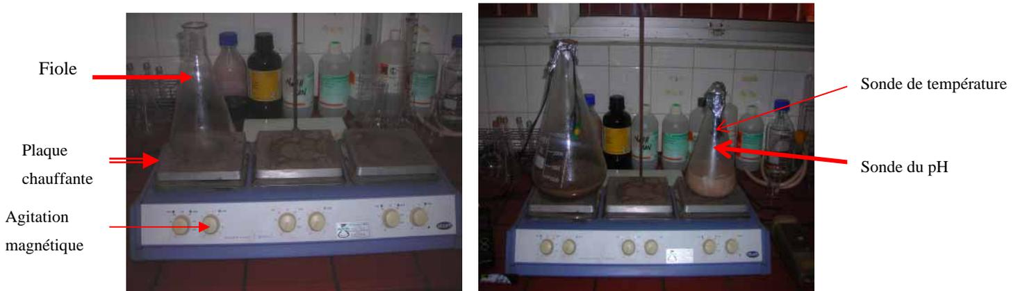
**Photo 5: Installation réalisée au laboratoire pour l'hydrolyse enzymatique contrôlée.**
