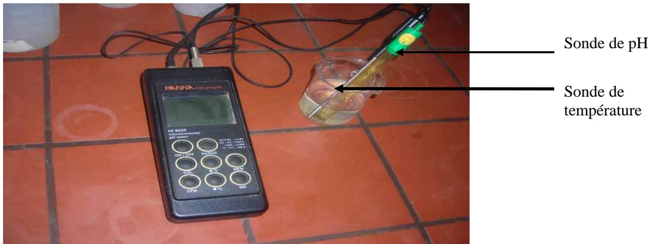
**Photo 4: pHmètre couplé au thermomètre**
