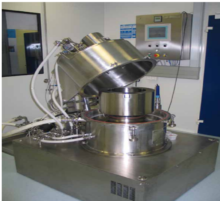
Figure 16. Appareillage muni d'un logiciel d'exploitation programmable pour une purification à grande échelle des globulines par l'acide caprylique, fait par Riera Nadeu (Barcelone, Espagne) [31].
