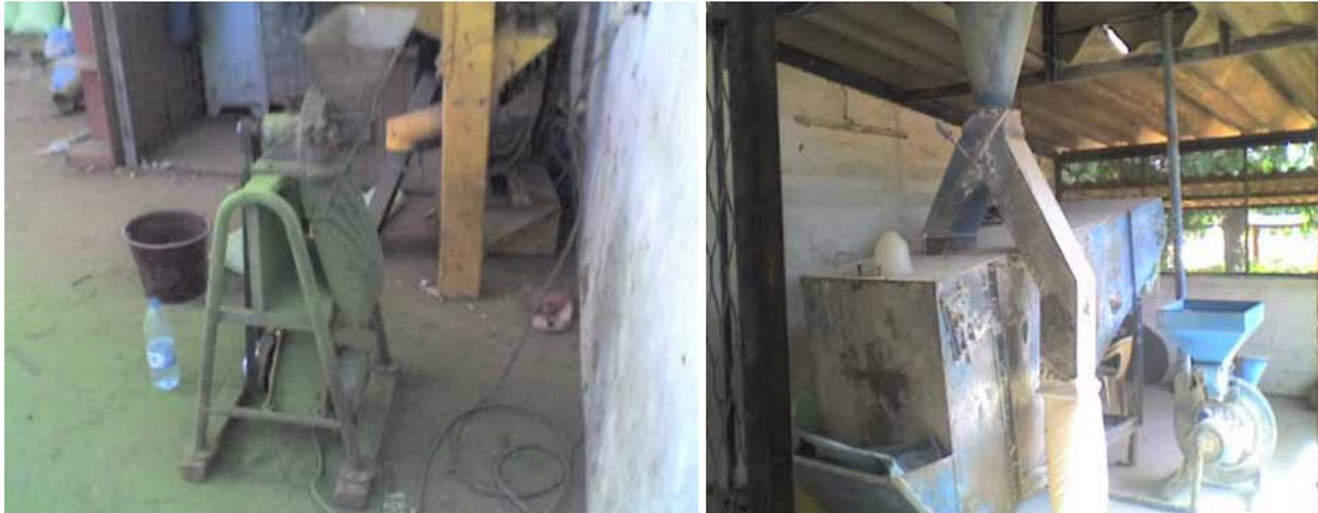
**Figure 11** : Le petit broyeur (à gauche) et le grand broyeur (à droite) servant à concasser des feuilles de légumineuses et d'autres ingrédients respectivement
