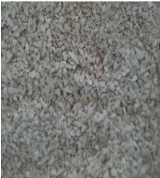
**Figure12 : Attapulgite après concassage et broyage**
