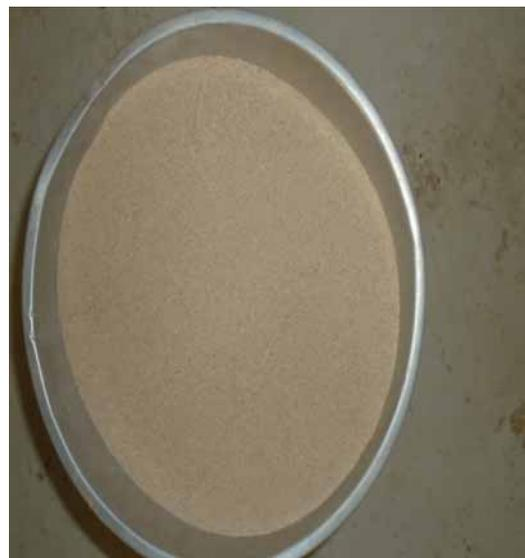
**Figure13 : Fines d'attapulgite calcinées**
