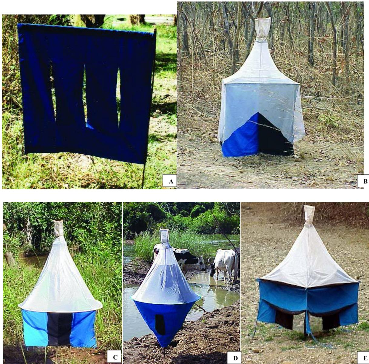
Figure 5: Ecrans utilisés dans la lutte : A : Ecran bleu imprégné d'insecticide, B : Ecran-piège, C : Piège monoconique, D : piège biconique, E : Piège tétraconique (**Kamuanga et al., 2005**)
