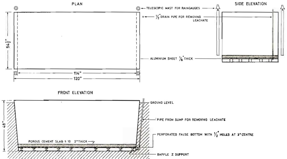
Fig. 20. Plan of a lysimeter
