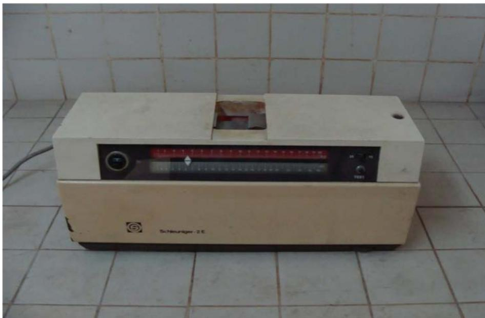
**Annexe1 : Duromètre de SCHLEUNIGER type 2E/205**
