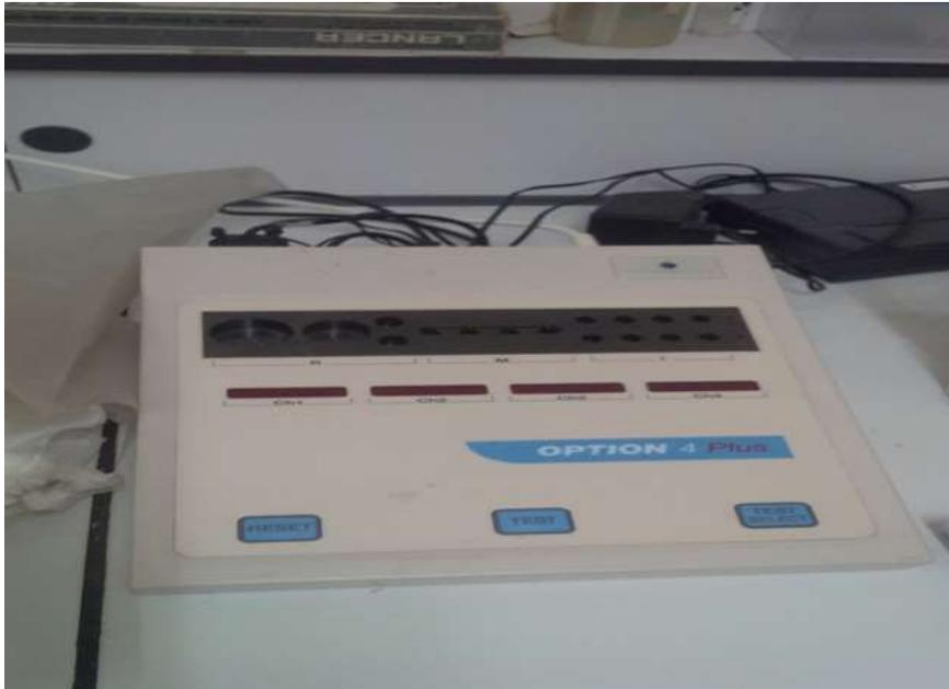
**Figure 3:** Coagulomètre option 4 plus de BioMérieux™
