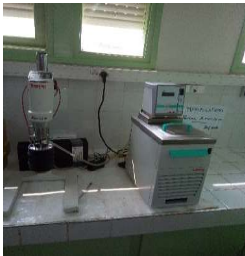
ANNEXE III: Viscosimètre rotatif HAAKE relié à un cryostat JULABO F12
