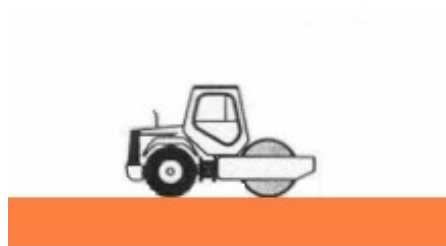
Phase 4 : Compactage de la plateforme
