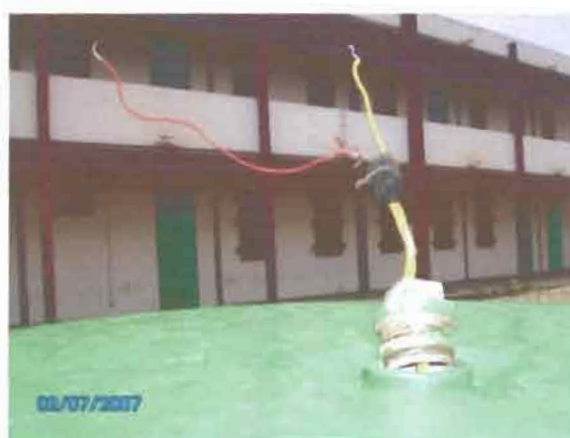
Figure III-2 : Bouchon avec thermocouple (réservoir)
