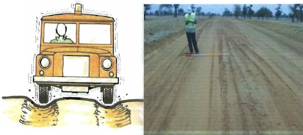
Figure IV.1: Schématisation d'ornière Figure IV.2: Exemple d'ornière sur la route de Fissel
