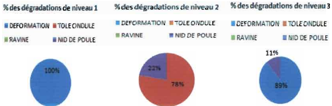
Figure V.11: diagrammes de répartition des dégradations par niveau de gravité N°11
