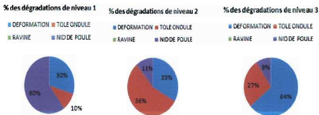
Figure V.10: diagrammes de répartition des dégradations par niveau de gravité N°10
