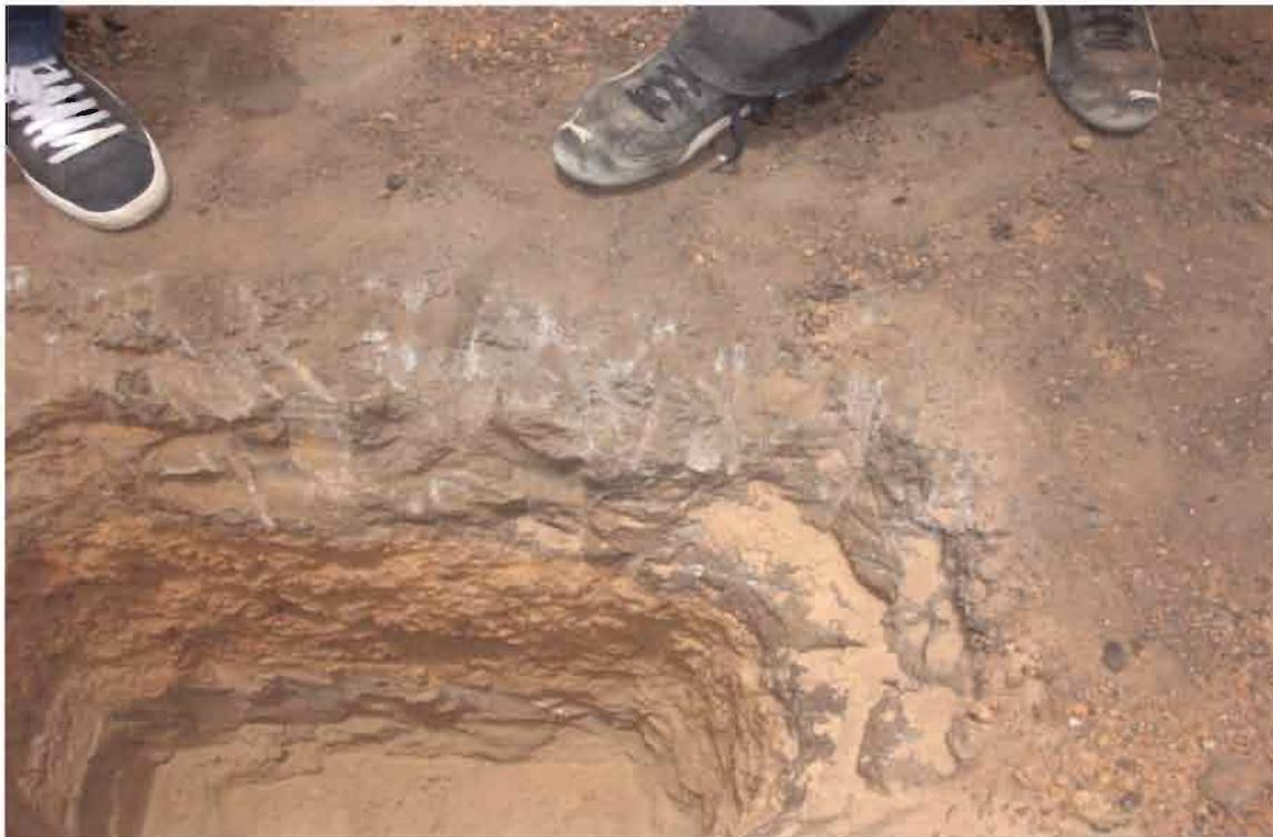
*Figure IV-4 Sondage S2 sur la planche expérimentale en sable-bitume*
