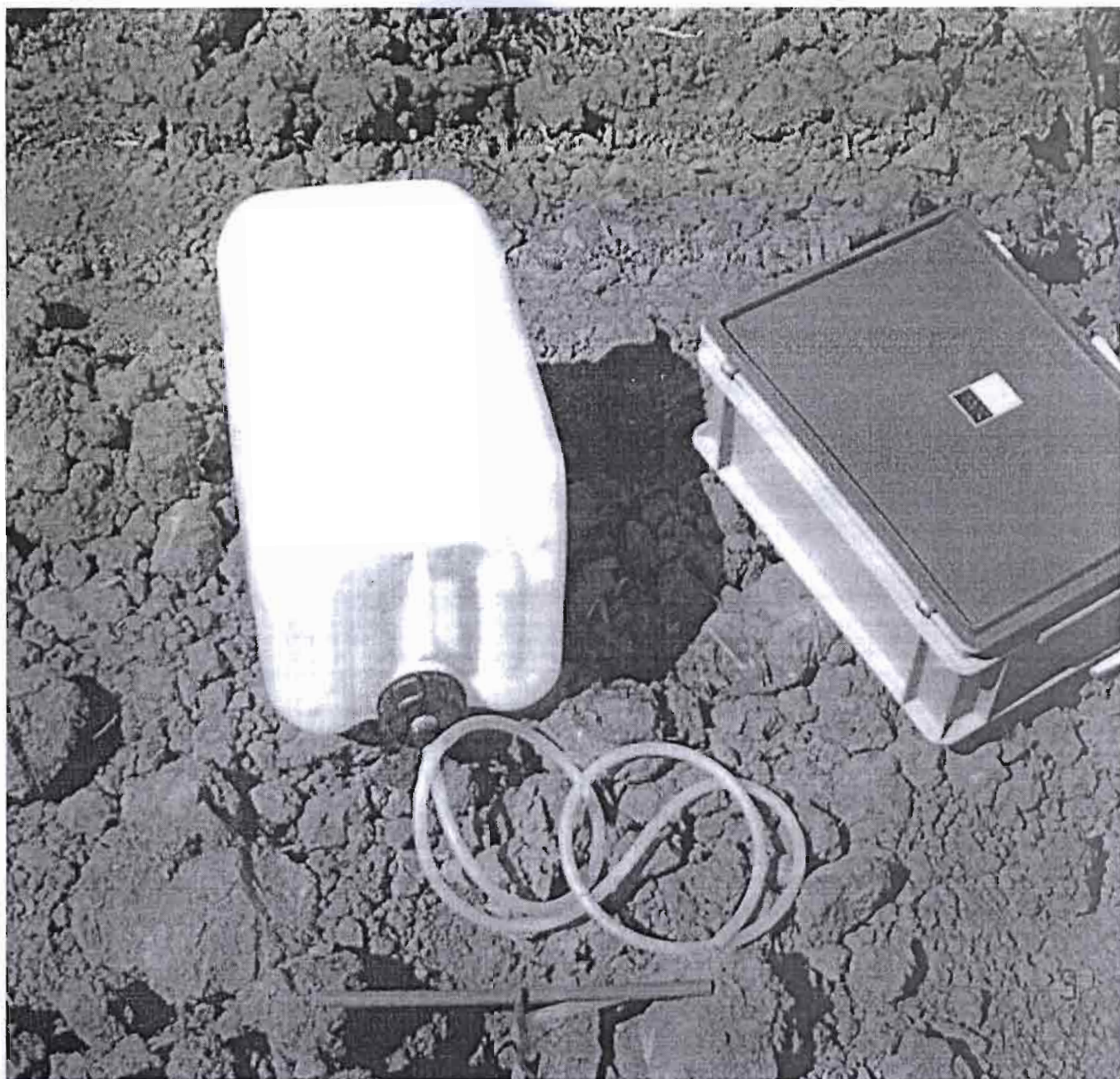
Infiltromètre : Appareil permettant de mesurer la perméabilité
