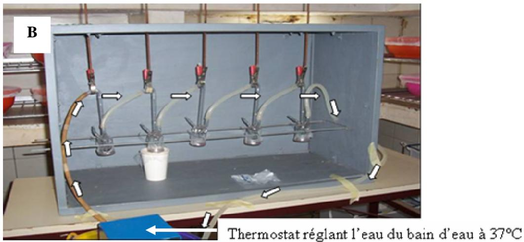
**Figure 2:** Représentation schématique du processus de l'infection artificielle d'anophèles (A) et dispositif expérimentale à l'insectarium (B, gobelet en lieu et place de la cage). Les flèches indiquent le sens du flux d'eau à 37°C à travers les cellules.
