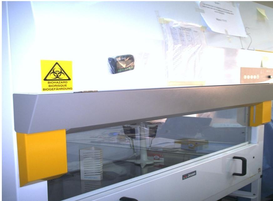
Figure 8 : Hotte à flux laminaire vertical Mini flux II ( ESI FLURANCE)
