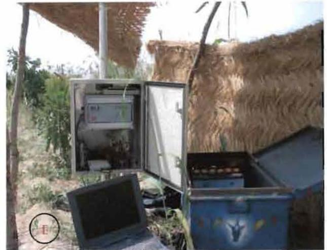
**Photo 2 : Installation des sondes et collecte des données de la transpiration sur des pieds de l'essai provenances de *Vitallaria paradoxa* (karité) à Gonsé, Burkina Faso**
