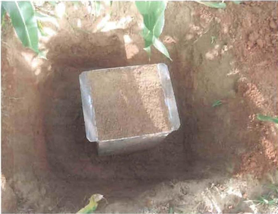
*Photo n° 1 : Le cadre métallique enfoncé dans le sol*
