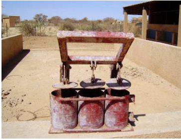
Photo 3 : Moule fabriqué localement pour les blocs
