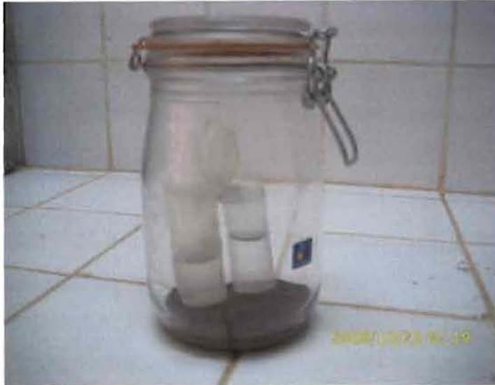
**Photo 6 : Test respirométrique**
