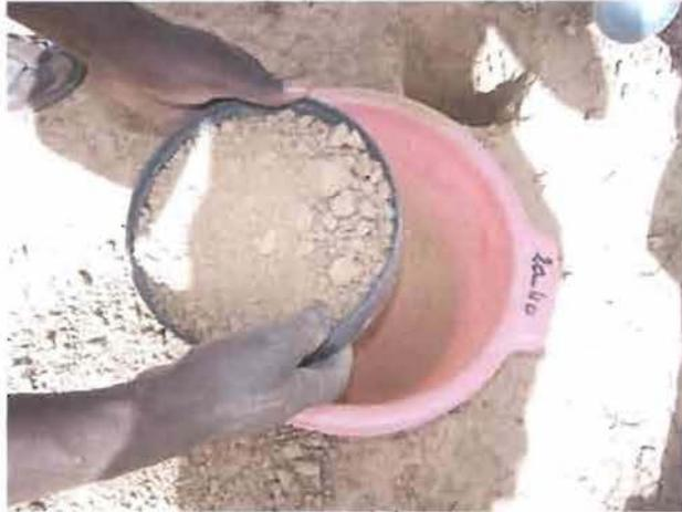
Photo 1 : Prélèvement et tamisage du sol
