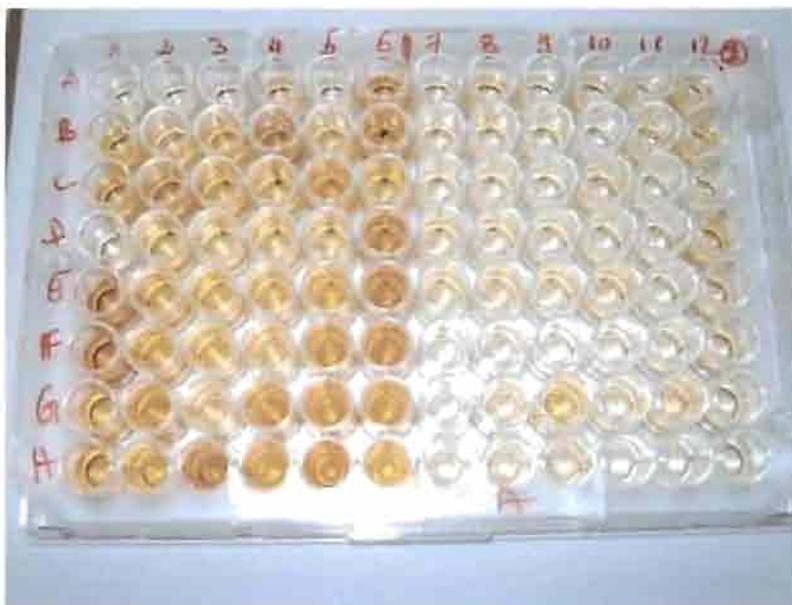
**Figure 10:** Résultat d'un test ELISA, coloration des puits après arrêt de la réaction.
