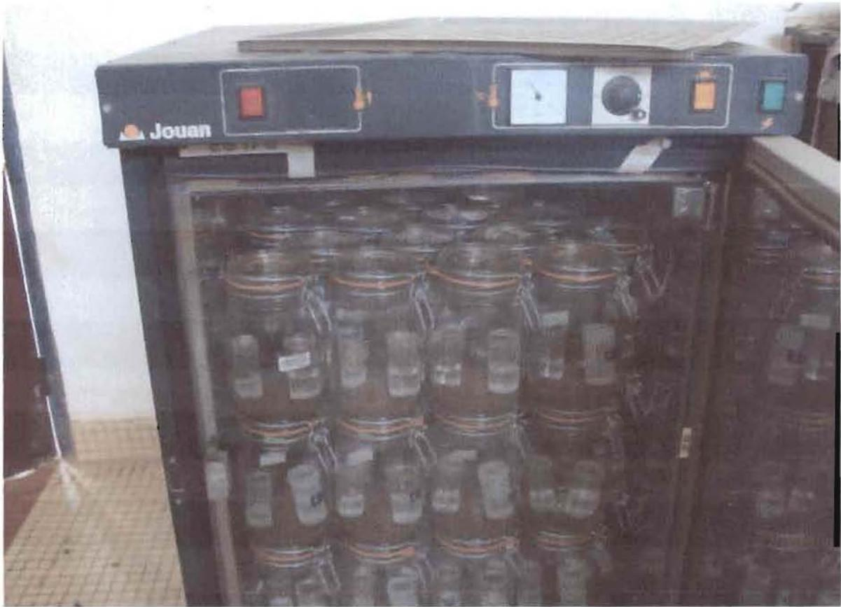
**Photo 3** : Incubation des échantillons de sol pour la mesure de C-CO<sub>2</sub> dégagé
