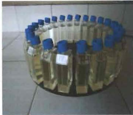
Photo 3 : Collection de 24 flasques de 50 ml sur le plateau en rotation pour incubation de l'inoculum
