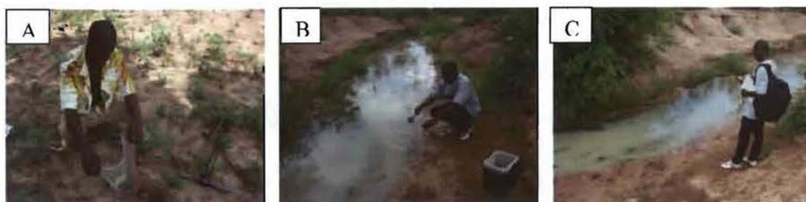
**Figure 5 :** (A) Prélèvement d'échantillons de sol, (B) Prélèvement d'échantillons d'eau, (C) Relevé de coordonnées géographiques au GPS
