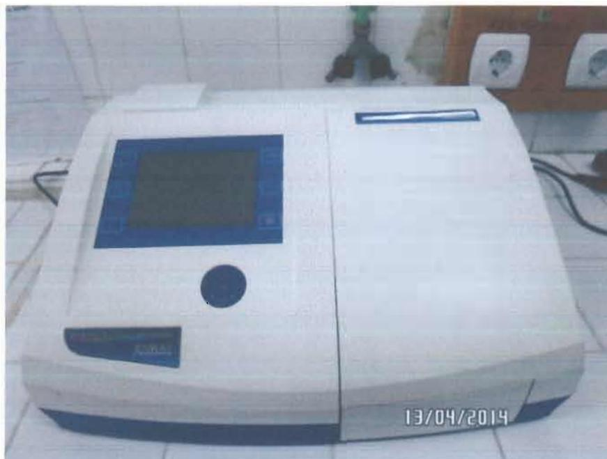
**Photo 3 : Spectrophotomètre**
