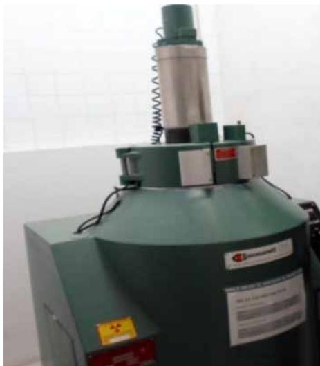
Figure 43: Irradiateur à rayon gamma ( $^{60}\text{Co}$ , IPCL, Seibersdorf)
