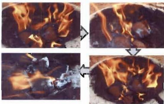
Photo 15 : Illustration de la combustion des briquettes de tourteau de baratte (0,6% de gommy blanc)
