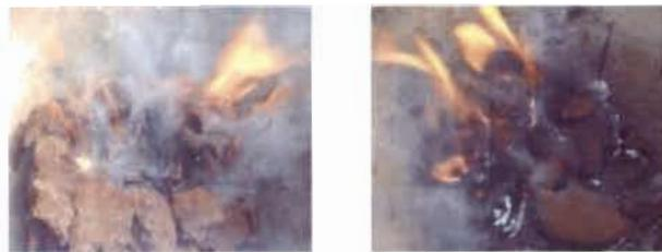
Photo 8 : Aperçu de la combustion des briquettes de tourteau de presse sans liant
