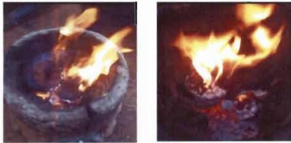
Photo 7 : Aperçue de la combustion des briquettes de tourteau de baratte sans utilisation de liant
