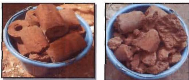
Photo 9 : Impact du transport sur une route endommagée sur les briquettes (baratte)
