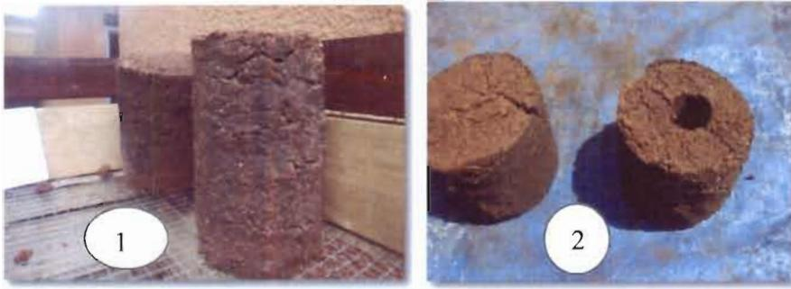
Photo 5: Briquettes petite et grande pleine (1) ; briquettes petites pleine et creuse (2) tourteau de presse (teneur en eau initiale de 53,5%)
