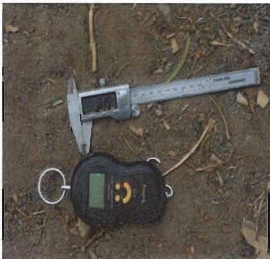
**Photo1 : Pied à coulisse et balance électroniques**
