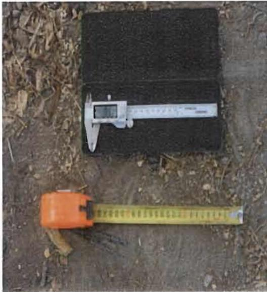
**Photo 14:** Pied à coulisse électronique et un mètre ruban
