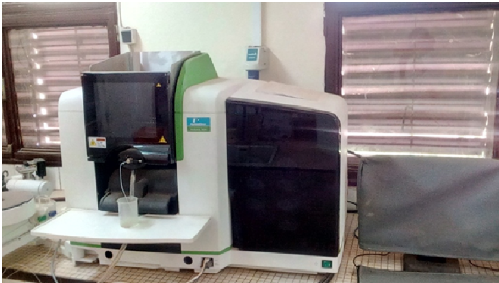
Photo 6 : Détermination du Ca total et du Mg total au spectrophotomètre à absorption atomique
