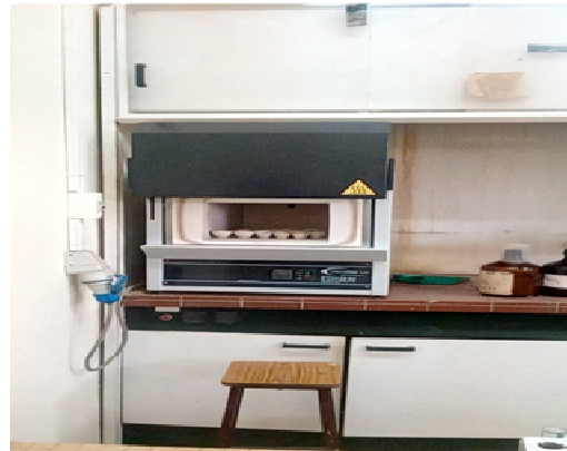
B-Calcination des échantillons de compost
