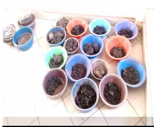
B-Séchage des échantillons de compost
