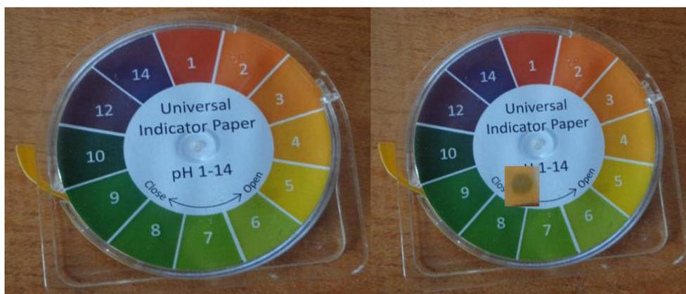
**Photo 5** : Détermination du pH de la laitance à l'aide d'un papier pH
