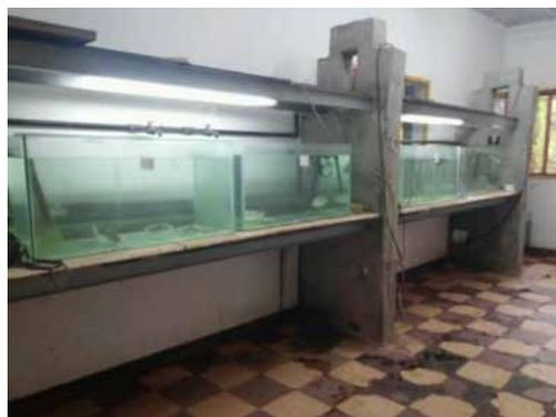
**Photo 2 :** Présentation du circuit fermé d'élevage constitué de quatre (04) aquariums de 300 litres chacun, utilisé au cours de l'expérimentation.
