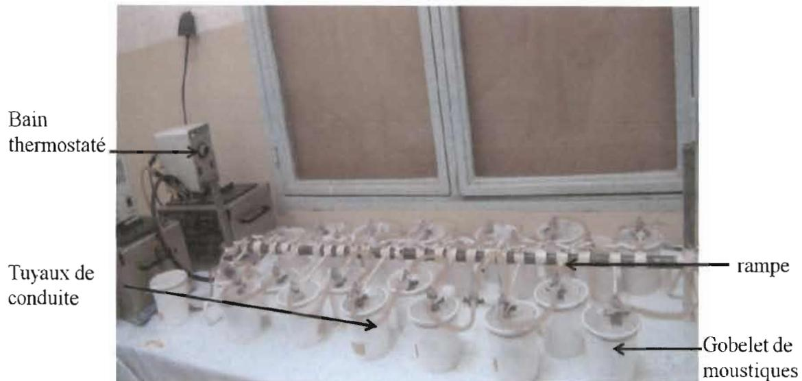
**Figure 1: Dispositif de l'infection expérimentale**
