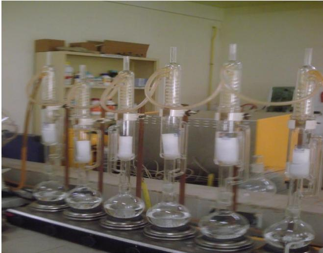
1. Dispositif du Soxhlet (Détermination LT)
