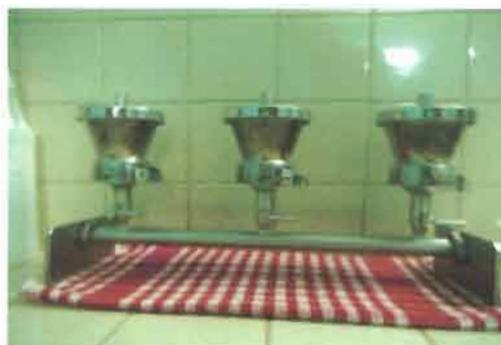
**Figure 1: Une rampe de filtration**
