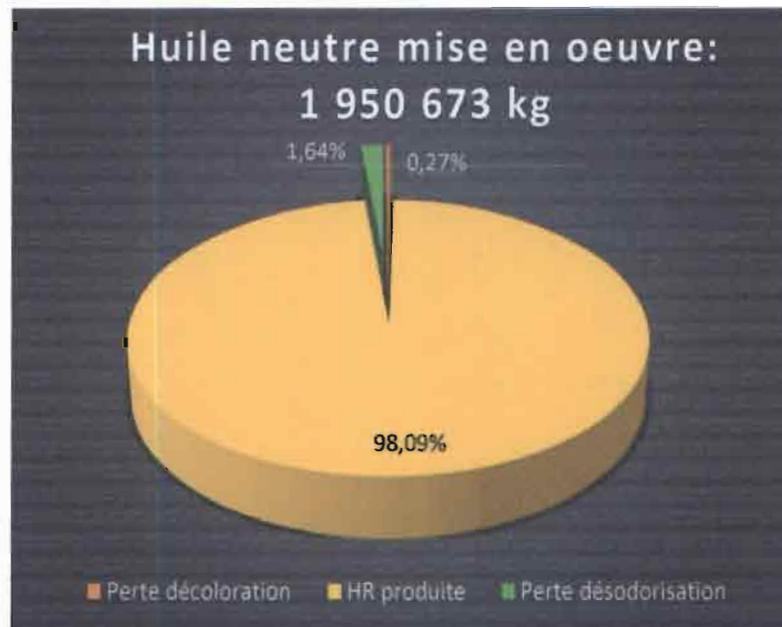
**Figure 8** : diagramme de répartition des pertes d'huile à la décoloration/ désodorisation
