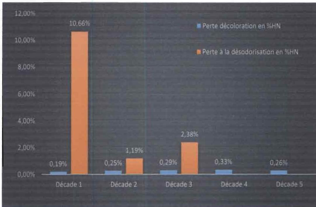
**Figure 7:** histogramme des pertes à la décoloration et à la désodorisation
