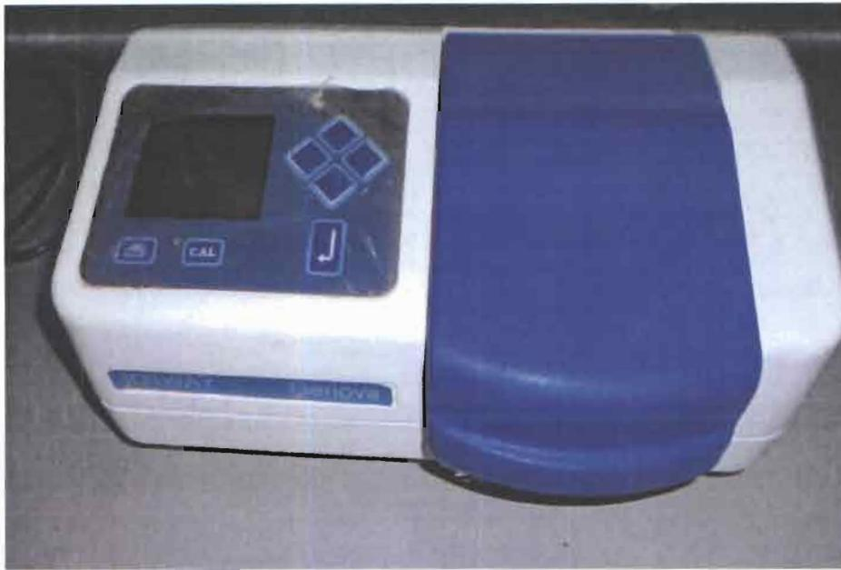
**Photo 3: Spectrophotomètre JENWAY GENOVA RS 232 (SANOU, 2016)**
